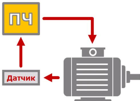
В ПЧ **ONI** используются новейшие технологии векторного управления, обеспечивающие достижение номинального крутящего момента на выходе при низкой скорости и бесшумный устойчивый ход.
