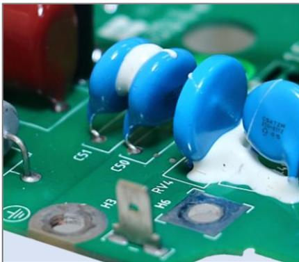
Силовая и управляющая платы покрыты защитным лаком в соответствии с промышленными стандартами.
